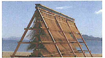
▲枝条架(流下式塩田) 海水を組みあげ塩分濃度を高める装置です。上部より海水を落とし巡回させ、太陽と風の力で海水の塩分濃度(3%)を18%くらいまで高めます。
